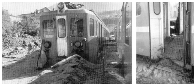
Doppelmotorvognen ABDeh 8/8 2041 på spor 2 i Brig og A 2071 på spor 3 i Brig. Vandet nåede til vinduerne på lokomotivet og vognene. Vand og slam er trængt ind og ødelagt inventar og motordele samt trækaksler.
